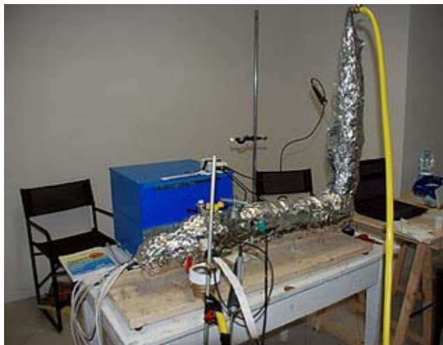
図 2. Rossi&Forcadi の熱発生装置の概観
